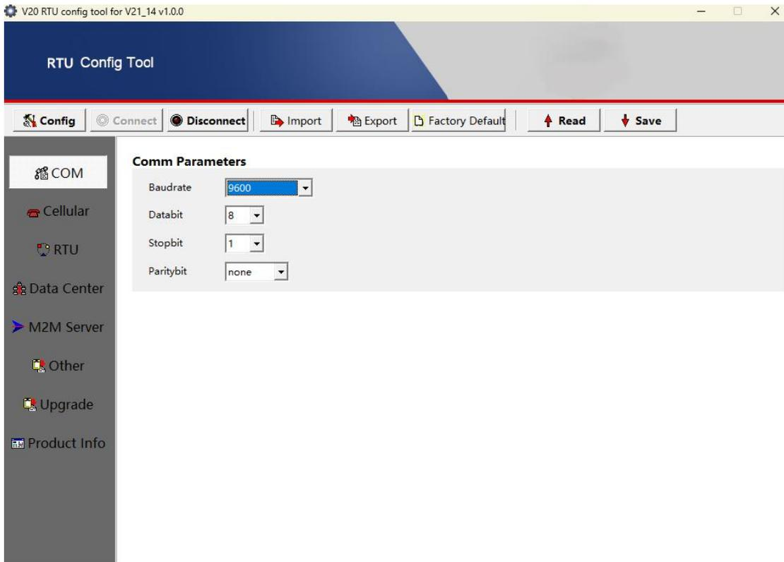
【Config】 Tool Serial port configuration.
